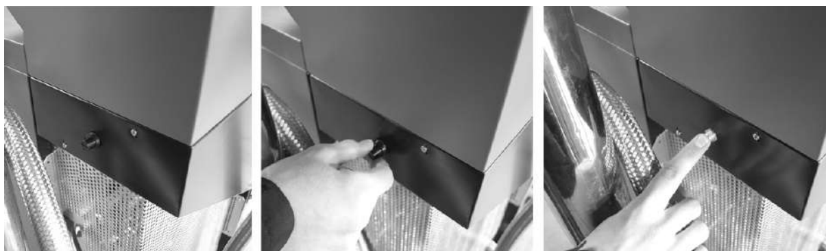
Рис. 17: Включение термического предохранителя
