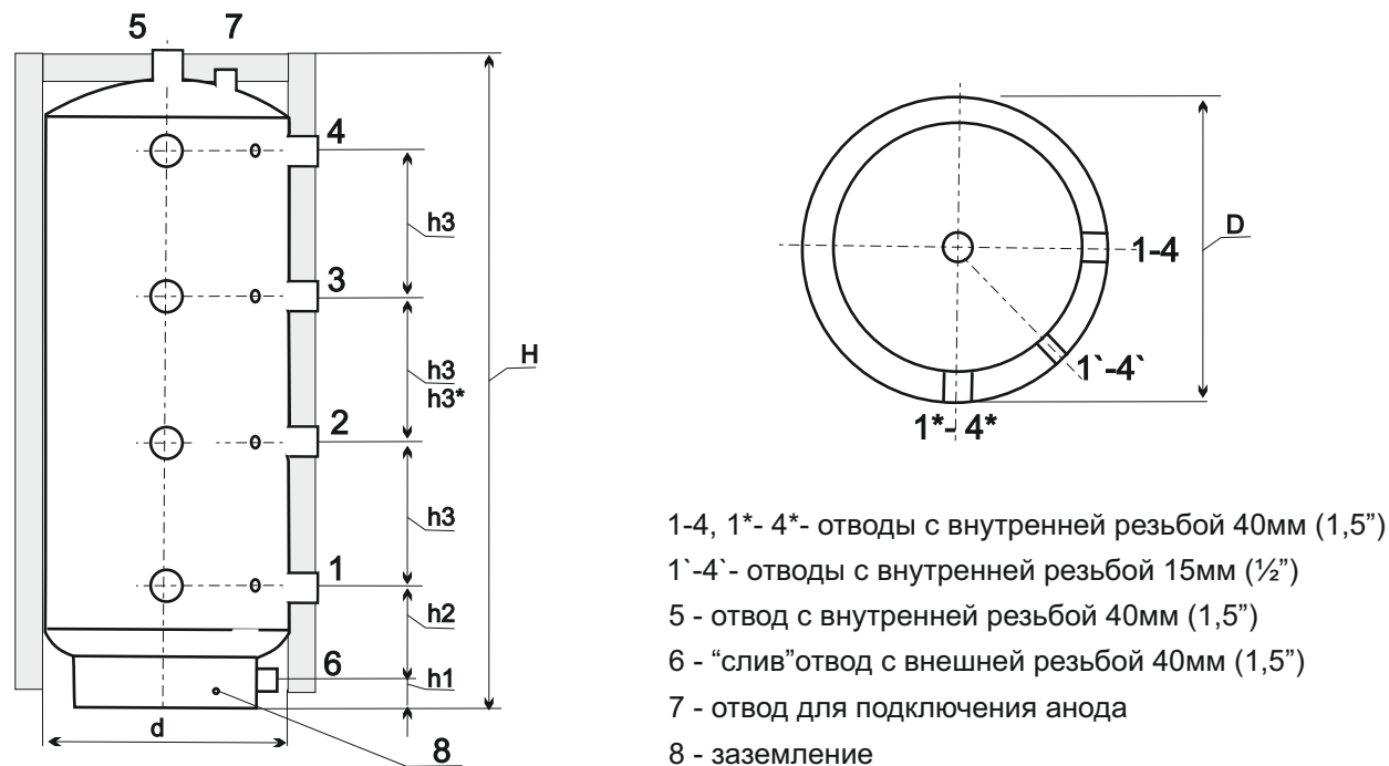
Рисунок 1. Схема подключения теплоаккумулятора серии ТА
